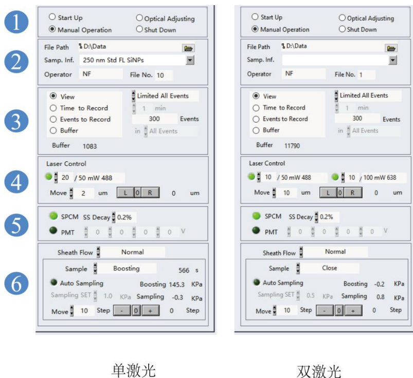
图 2-7 仪器控制面板（左边是单激光，右边是双激光）
