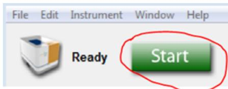
b) 如果未显示上述图标，表明软件未连接到仪器。点击Instrument，然后点击Connect，出现绿色的Start，表明已连接至仪器。
